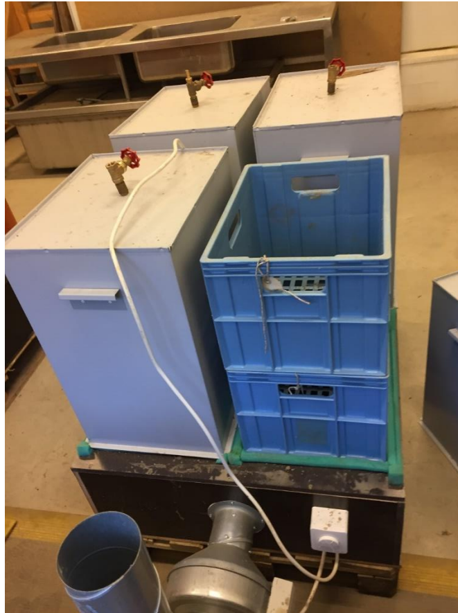
Bilde 3 Kålrot ble lagret i ventilasjonskasser med vifte med regulerbar hastighet i bunn og åpning på topp. Kålroten ble lagret i 20 kg's kasser med netting i bunn. På lokket er det en åpning på topp med mulighet for regulering av luft med kran.
