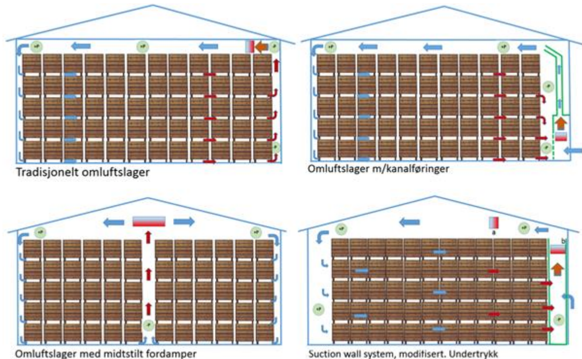
Figur 23. Fire ulike prinsipper med omluftslager.
