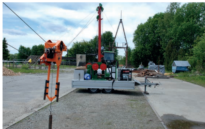
Testing av løpekatt på Owren 400 minitaubane (Foto: Morten Nitteberg)
