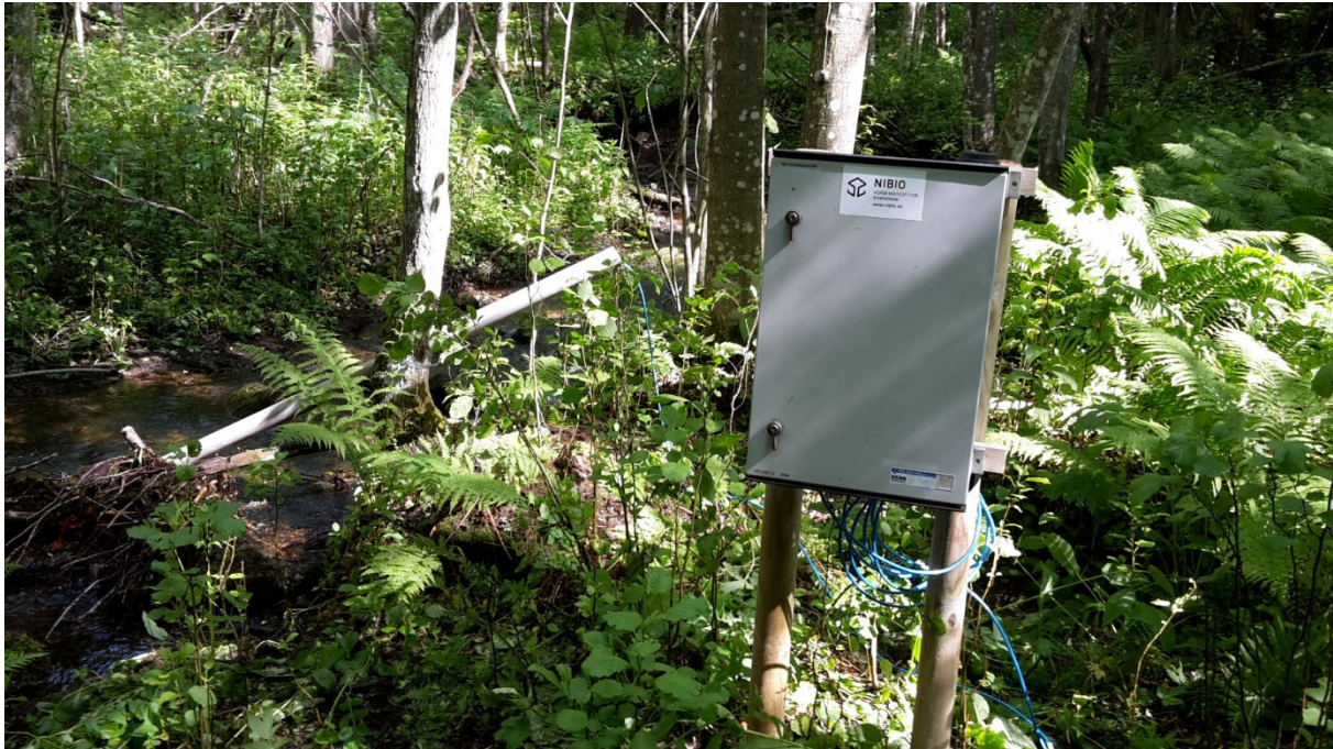
Figur 9. Stasjonen NOR i Nordlandsbekken. Viser utstyr for automatisk overvåking etablert for Ringeriksbanen i 2017 og stasjon for uttak av vannprøver, bunndyr og begroingsalger 2018 og 2019 (Foto: Roger Roseth, NIBIO).
