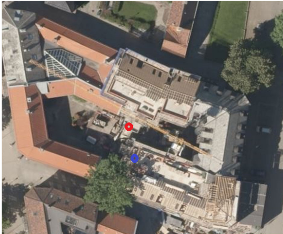
Figur 1a. Flyfoto som viser tomten med nybygg og hvor sensorer er satt inn i profil nord (rød) på utsiden av nytt bygg og profil sør (blå) under nytt bygg.
