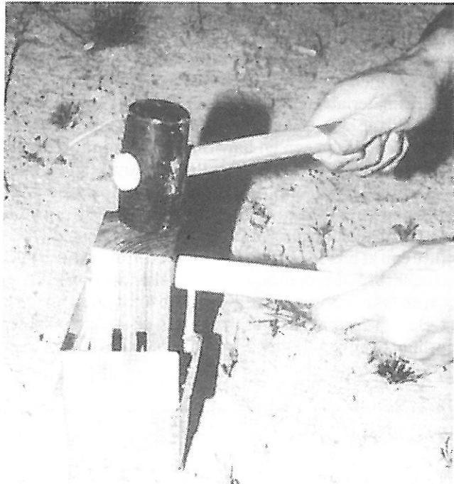
Fig. 10. Materialet pakkes i prøveboksen (Foto: I. Lindstrøm) Compacting the material
