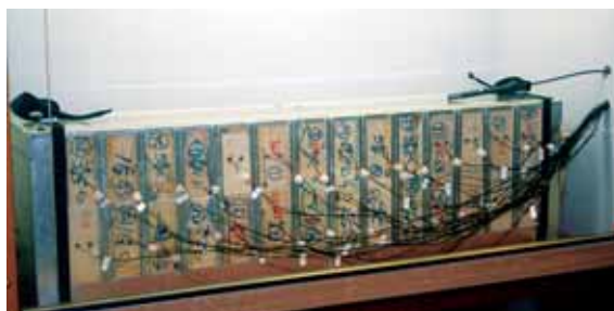
Figur 2. Testing av kledningsprøver i Mycologg. Foto: Mari Sand Sivertsen.
