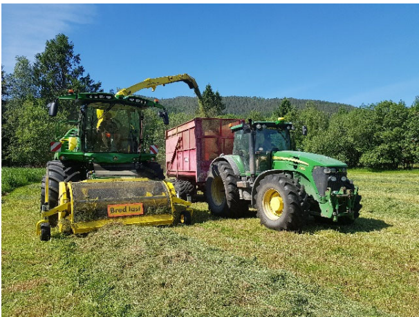
Figur 5.4 Snitteslessevogn til venstre og finsnitter til høyre (Foto: Jan Karstein Henriksen).
