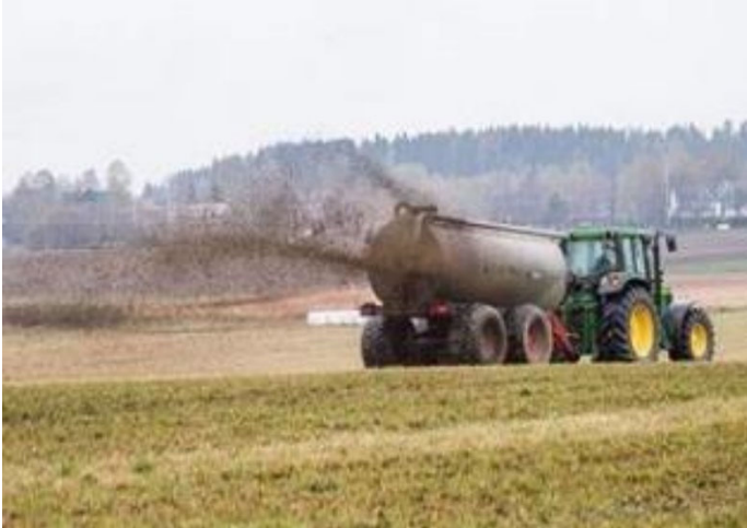
Figur 5.1 Gjødselvogn med fanespreder brukt i T1 (Foto: NIBIO).
