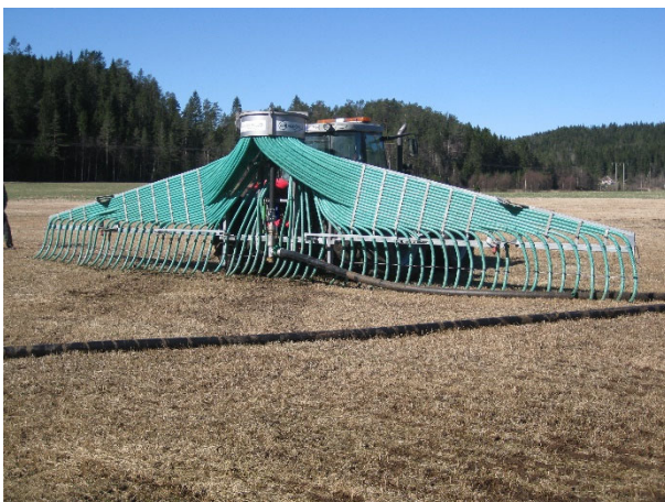
Figur 5.3 Slepeslange med stripespreder (Foto: Jan Karstein Henriksen, NLR).
