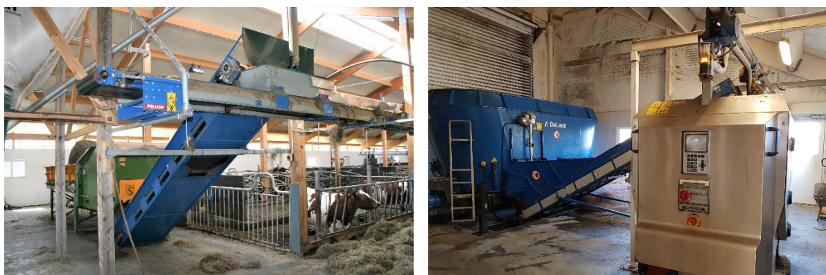
Figur 5.9 Rundballekutter og båndfôring i taket til venstre (Foto: Geir Næss), stasjonær fullfôrmikser og fôrutlegger på skinne til høyre (Foto: Rose Bergslid).
