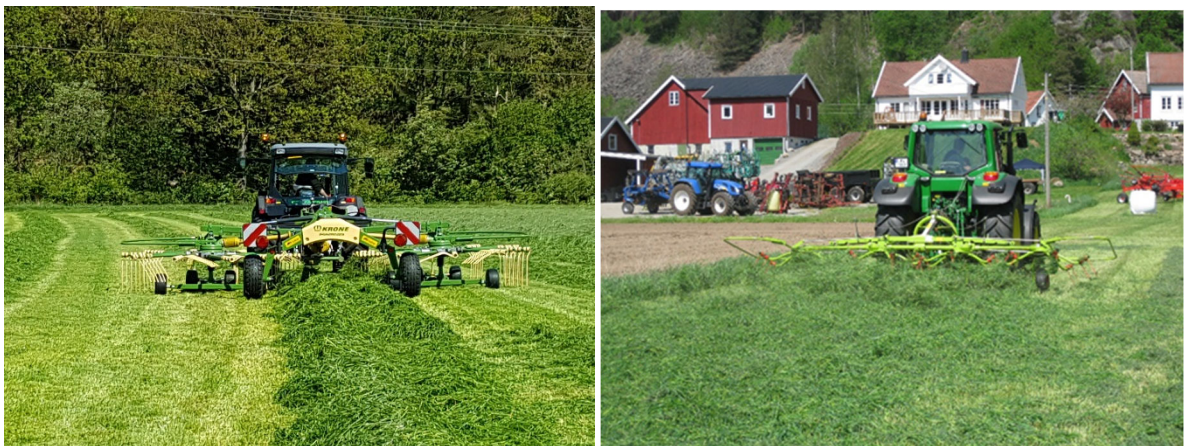
Figur 5.8. Samlerive til venstre og sprede + venderive til høyre (Foto: Jan Karstein Henriksen).
