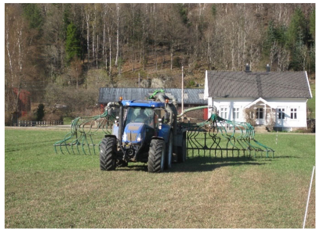
Figur 5.2 Tankvogn med nedlegger til venstre og tankvogn med stripespreder til høyre (Foto: Jan Karstein Henriksen, NLR).
