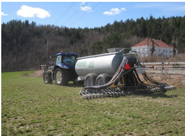
Figur 5.2 Tankvogn med nedlegger til venstre og tankvogn med stripespreder til høyre (Foto: Jan Karstein Henriksen, NLR).
