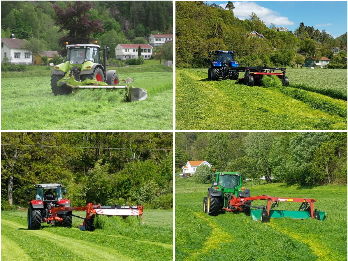
Figur 5.7 Slåmaskiner med og uten crimper som legger i streng og bredspredning. Bildet i andre rad til høyre viser slåmaskin uten crimper som kan bredspre til ca. 90 prosent av arealet (Foto: Jan Karstein Henriksen).
