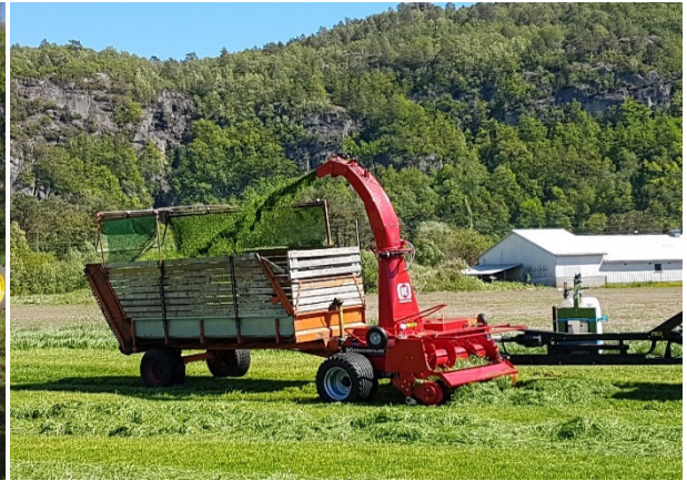
Figur 5.4 Snitteslessevogn til venstre og finsnitter til høyre (Foto: Jan Karstein Henriksen).
