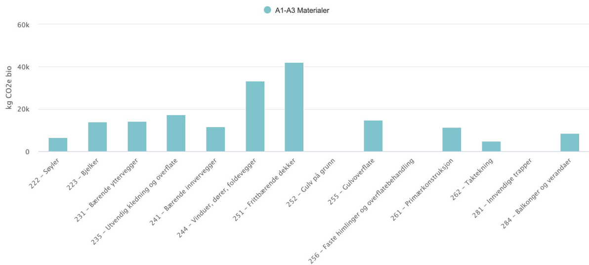
Figur 8. Biogent karbon lagret i treprodukter (A1-A3) i en boliglavblokk tre etasjer bindingsverk på ca. 1140 m 2 bo-/bruksareal. Bindingsverk av tre. Fordelt på bygningsdeler. Kilde: Eivind Selvig beregnet i One Click LCA
