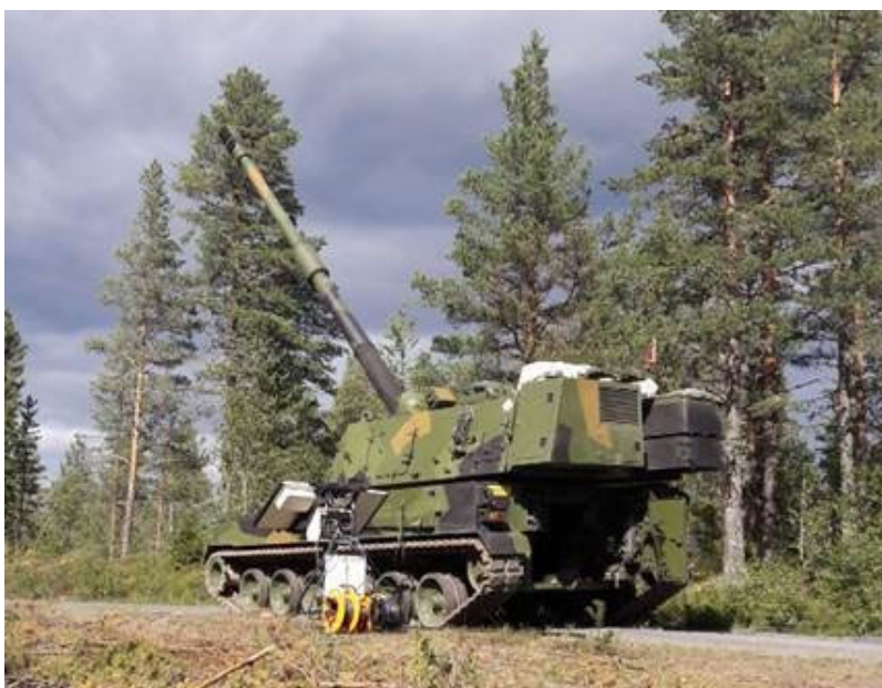
Bilde 5. Artillerikanon under testskyting med støymåler satt opp ved siden av. Foto: Hrafn Mar Sveinsson.
