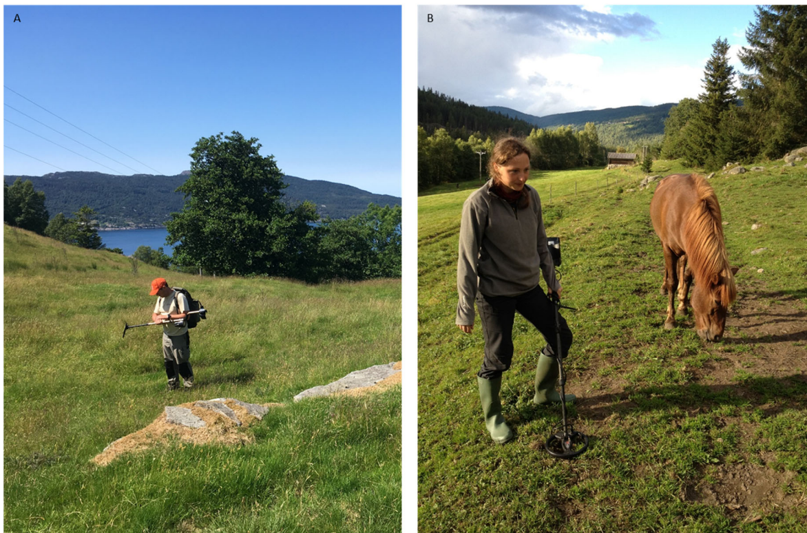
Figur 5: GPS ble brukt til å komme i nærheten av analyseruta (A). For å finne aluminiumsrørene som stod i hvert hjørne av ruta og i senterpunkt ble metalldetektor benyttet (B). Foto: Ulrike Bayr og Christian Pedersen/NIBIO.
