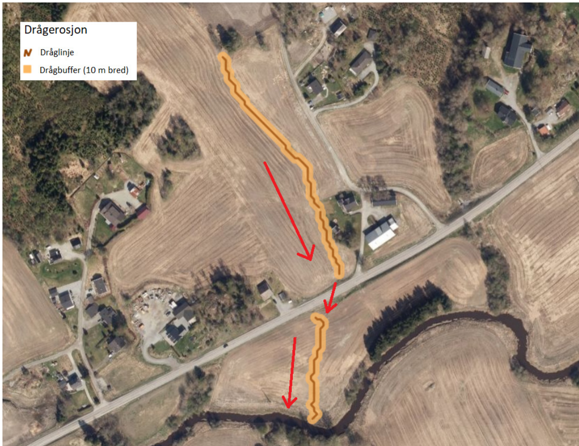
Avrenning fra dråg ledes under veien gjennom stikkrenne, og kommer ut på arealet nedenfor veien (røde piler viser i hvilken retning vannet renner). Flybilde og kart: © Kartverket, Geovekst, NIBIO
