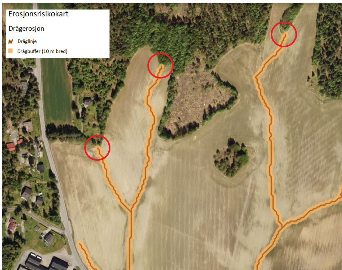
Erosjon kan oppstå der overflateavrenning kommer inn (røde sirkler) på jordbruksareal fra tilgrensende utmarksareal. Flybilder og kart: © Karverket, Geovekst, NIBIO
