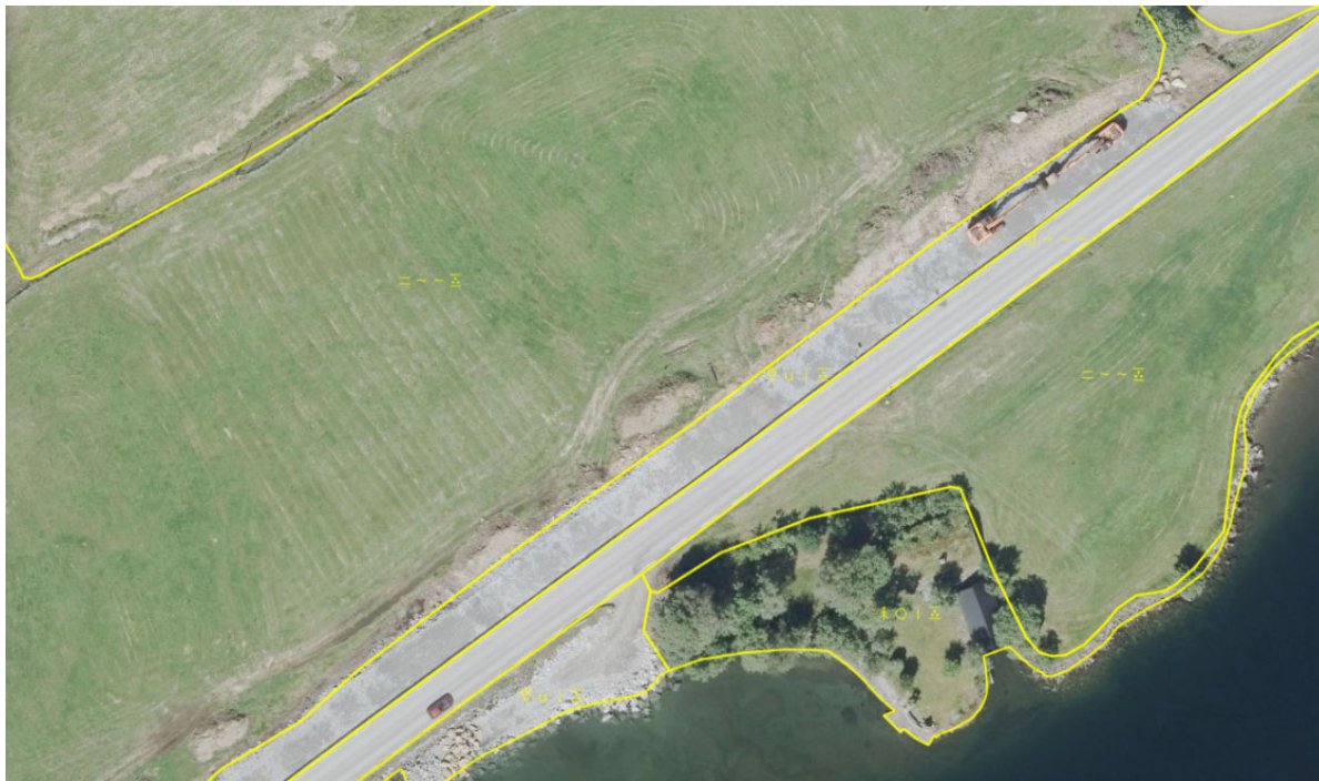
Figur 27: Vegbygging pågår, og arealet der den nye traseen skal ligge er mellombels omklassifisert frå fulldyrka jord til åpen fastmark i AR5.
