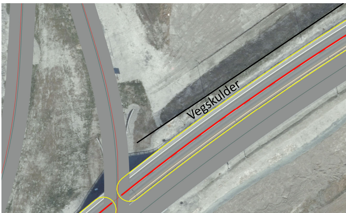
Figur 26: Detaljutsnitt frå same område. Rød linje viser ny veg i årsversjon 2018, og gult omriss viser beslaglagt dyrka jord. Nye flybilder viser situasjonen etter utbygging. Her er reelt beslaglagt dyrka jord større enn det som vert fanga opp med dei estimerte vegbreddene vi har brukt. Utsnittet viser at dyrka jord langs vegskulderen ikkje vert fanga opp.
