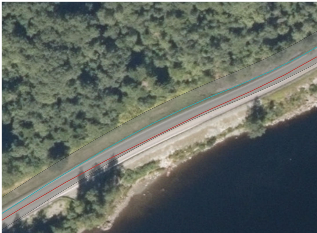
Figur 10: Buffer rundt veg i årsversjon 2018 (i turkis) fangar opp forbedring av geometrien, slik at den raude linja i årsversjon 2019 ikkje vert rekna med som ein ny veg.
