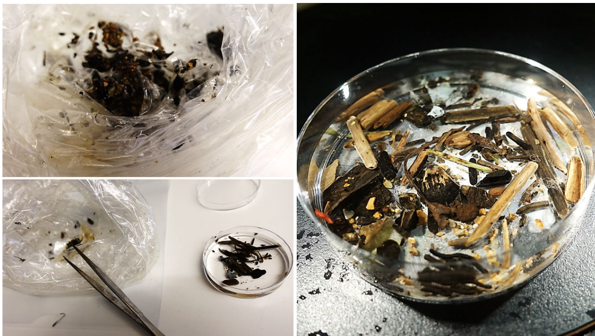
Figur 2. Plastpose med materiale tatt fra grovfilter i snøkanonene i Sørkedalen. Det var både grus og biologisk materiale som trefliser, frø, kongleskjell og barnåler. Alt ble skylt i sterilt vann før isolering på agar. Foto: Venche Talgø
