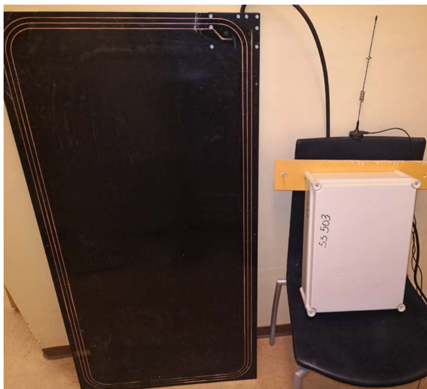
Stasjonær sender/avleser (t.h.) med plateantenne (t.v.) fra Biocontrol AS (Foto: Erlend Winje)
