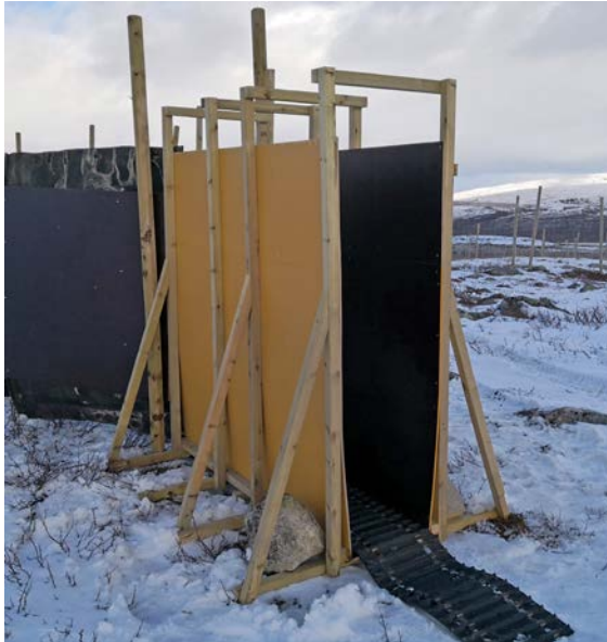
Bildet til venstre viser mobil sluse for avlesing av RFID-merket rein, Helligskogen reinbeitedistrikt. Til høyre vises plateantenne (sort til venstre i bildet) med sender/avleser (boks til høyre i bildet) ferdig oppmontert ved sluse, Råkkonjårga reinbeitedistrikt (Foto: Erlend Winje)
