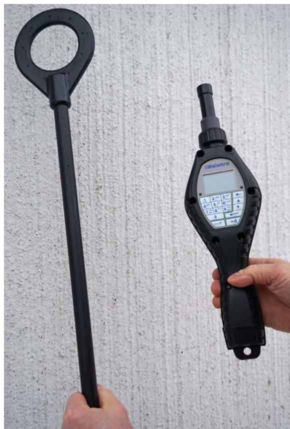
Håndholdt sender/avleser type HRR 3000 Pro V2 med to forskjellige antenner (Foto: Tor-Arne Bjørn)
