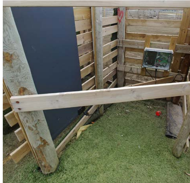
Bildet til venstre viser mobil sluse for avlesing av RFID-merket rein, Helligskogen reinbeitedistrikt. Til høyre vises plateantenne (sort til venstre i bildet) med sender/avleser (boks til høyre i bildet) ferdig oppmontert ved sluse, Råkkonjårga reinbeitedistrikt (Foto: Erlend Winje)
