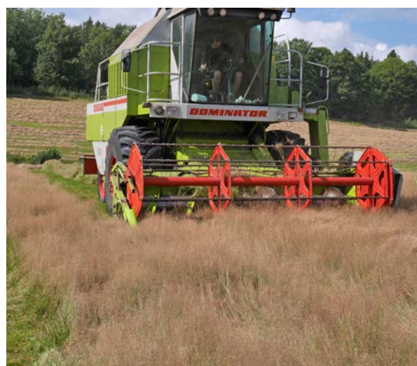
Bilde 2. Kontrolltresking med konvensjonelt skjærebord 19. august 2020 på ruter som var høstet med ribbeskjærebordet fire dager tidligere. Foto: John Ingar Øverland.
