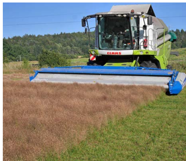
Bilde 1. Kjøring med konvensjonelt skjærebord (til venstre) og ribbeskjærebordet (til høyre) i engkveinfreng 15. august 2020. Foto: John Ingar Øverland.
