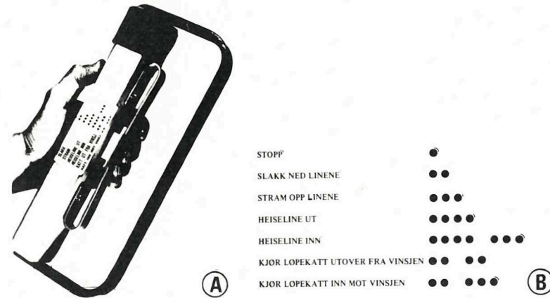
Fig. 37. A : Snorre-tuteren. B : Lydsignaler for vinsjunning og kabelkrantransport.
