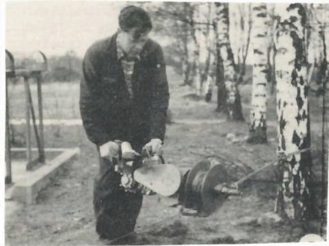
Fig. 39. Monteringsvinsj montert på motorsagmotor.
