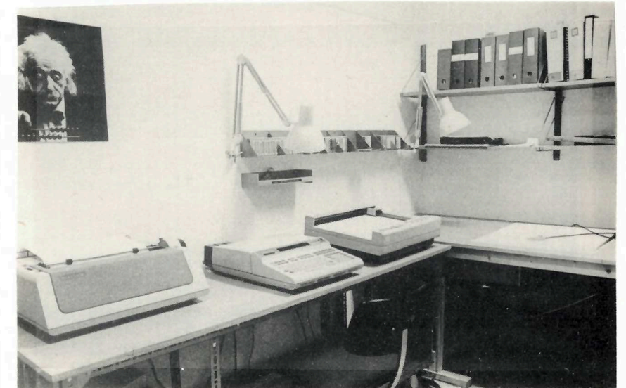
Fig. 2. Hewlett Packard programmerbar bordkalkulator HP 9825 B. Fra venstre mot høyre: Skriver, kalkulator, plotter, kart på digitaliseringsbrett.
