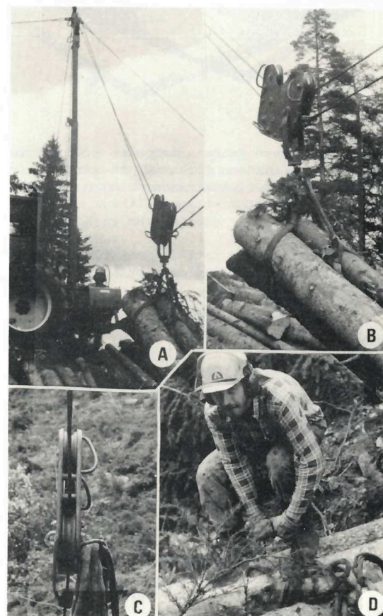
Fig. 82. Forsøksdrift i Åsgrend, 1980. A og B : Lasset kommer inn til velteplassen. C : Tom løpekatt med fiberstropper ferdig til returtransport. D : Løsning av fiberstroppene på velten.
