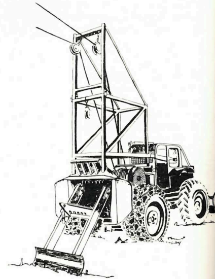
Fig. 33. Støtteforankring kan erstatte bardunering av tårnet.
