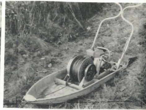
Fig. 40. Den østerrikske ACKJA monteringsvinsj.
