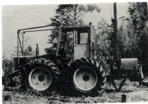
Fig. 71. Iglands interlukkede vinsj monteret på en Ford County traktor.
