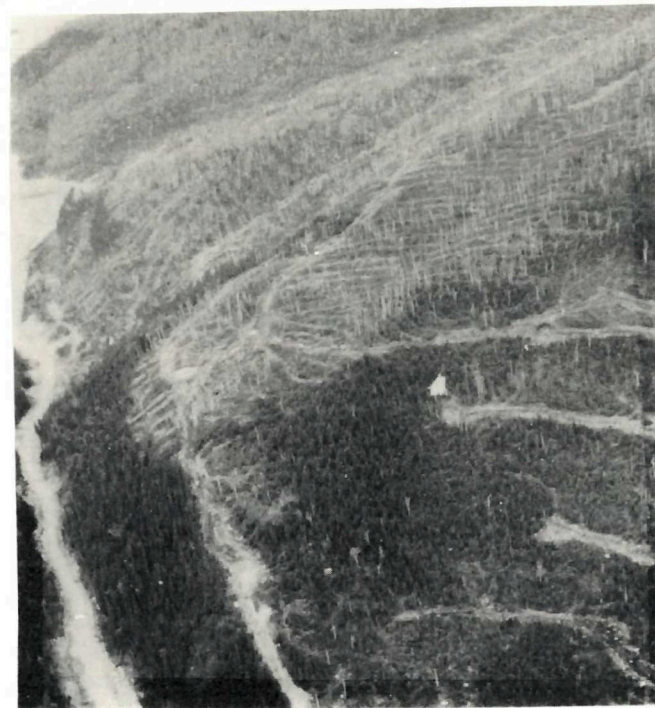
Fig. 9. Terrasseveger ved Forestville, Quebec, Ost-Canada. I forgrunnen 200 m vegavstand for vinsjunning. I bakgrunnen 40 m vegavstand for traktorlunning.
