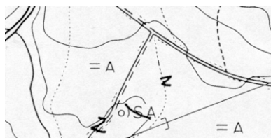
Figur 3. Eksempel på korrekt overstryking av markslagssignatur og uthaking av markslagsgrense med "N".
