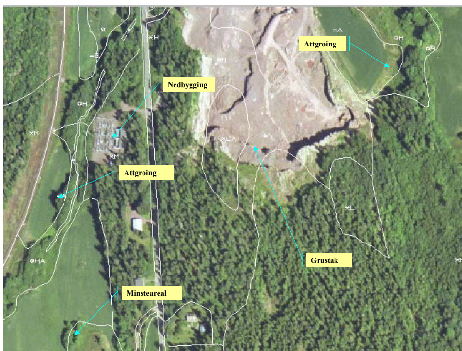
Figur 6. Nokre av feilsituasjonane på dette utsnittet er lette å oppdage ved bruk av ortofoto, men kan lett bli oversett ved tradisjonell metode (tolking av flybilete og overføring til kart).
