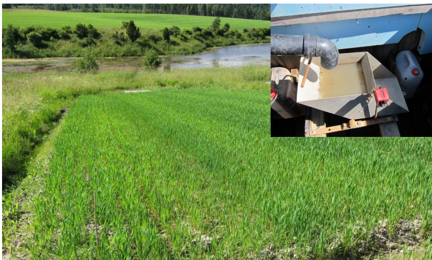
Figur 2-5. Avrenningsforsøket på Øsaker. Oppsamling av overflateavrenning i en renne nederst på ruta som ledes til en hytte med utstyr for å måle vannmengder og ta ut vannprøver (innfelt bilde).
