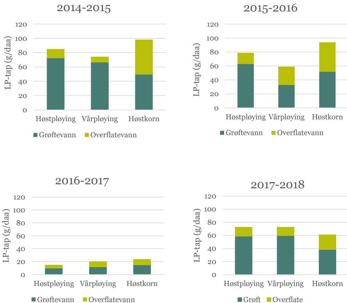
Figur 14. Tap av løst ortofosfat (LP) beregnet ut fra konsentrasjoner målt i grøfte- og overflateavrenning fra ulike jordarbeiding for forsøksperioden 2014-2018 (Bechmann m. fl., 2019).
