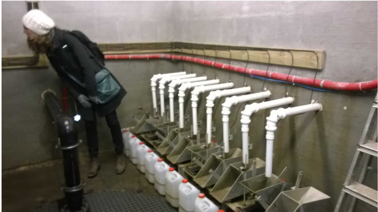
Figur 5. Målehytte med vippekar for vannprøvetaking av drensvann og overflatevann (Foto: Eklo, NIBIO).
