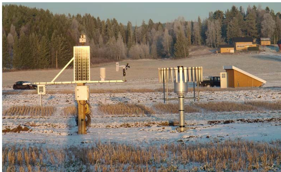
Figur 2. Klimastasjon med solcellepanel og webkamera med utstyr for temperatur, nedbør, luftfuktighet og vind innstråling. (Foto: Eklo, NIBIO)
