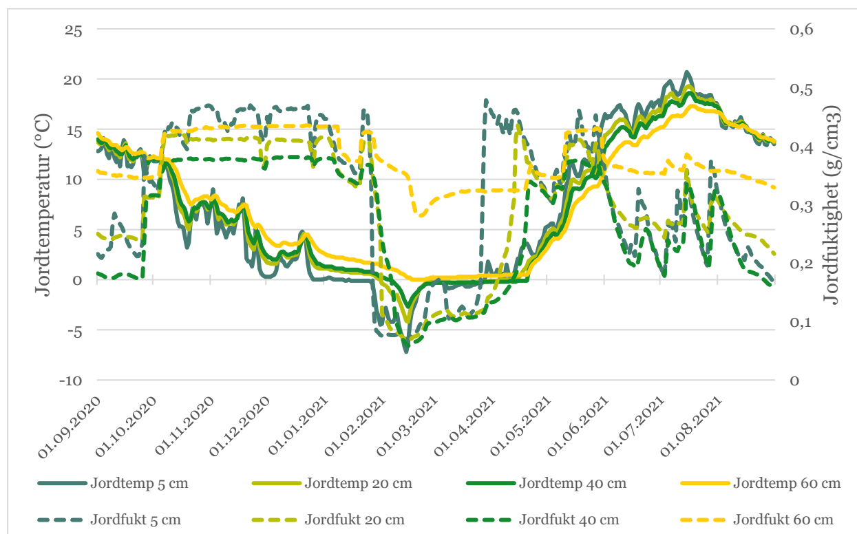
Figur 5.10 Jordtemperatur og vanninnhold målet i jordprofil 1, i forsøksperioden 2020-2021.
