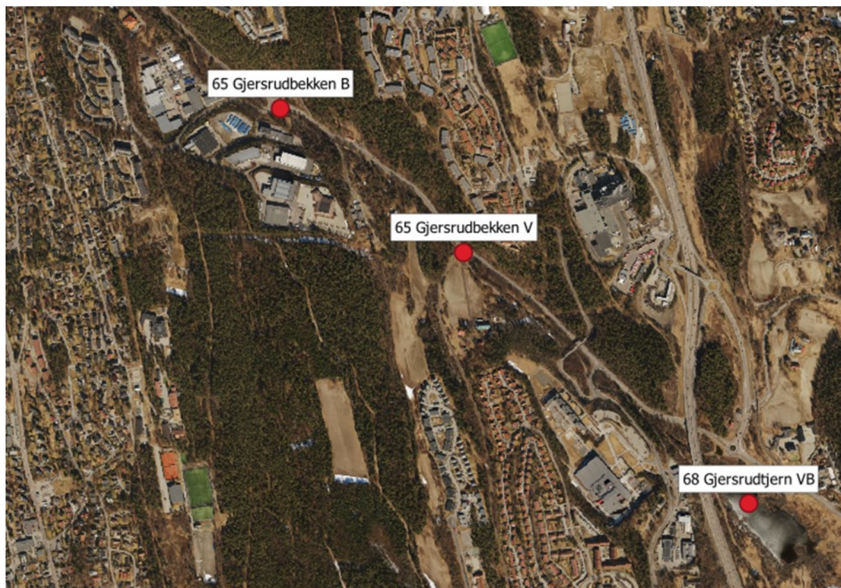
Figur 1. Overvåkingstasjoner nord for anleggsområdet på Åsland for kontinuerlig overvåking og/eller vannprøvetaking og fisk- og bunndyrundersøkelser. V= Vannprøver. K= Kontinuerlige målinger. B= Biologiske undersøkelser.
