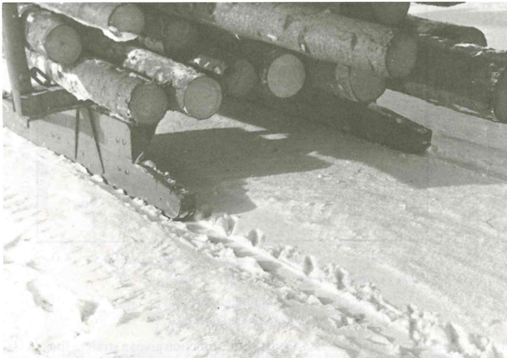
Fig. 13. Timber loaded on a sleigh with four runners. (SAMSET 1956) Tømmerlass transporteres på doning med fire meier.
