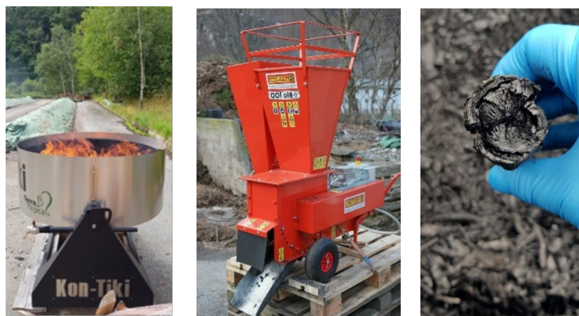
Figur 13. fra venstre A) Kon-Tiki enhet for produksjon av biokull, B) Kompostkvern brukt til knusing av biokull. C) Biokull fra park- og hageavfall. Bilder: Sogn Jord- og Hagebruksskole
