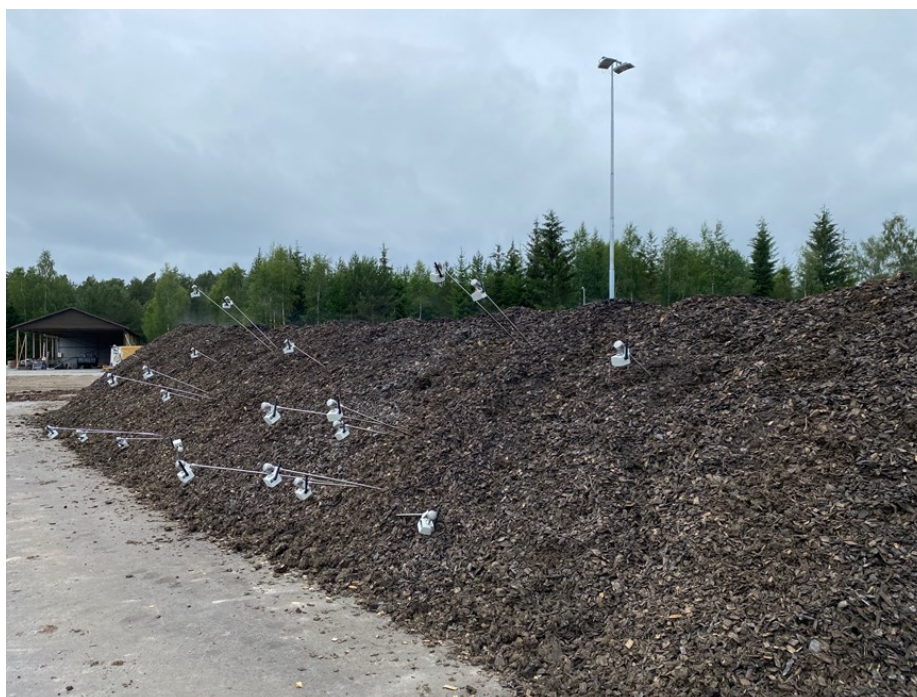
Figur 5. Trådløse temperatursensorer levert av Endress og Hauser plassert i forsøksranke for å modellere temperaturene i ranke før og under vending (Foto Elling Ødegaard, Maarud).
