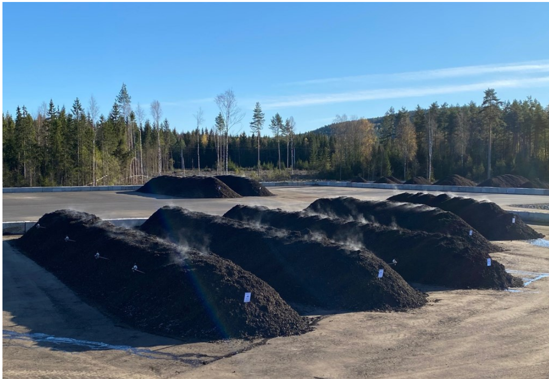
Figur 3. Viser aktive kompostranker på rød sone i front ettermodningsranker på gul sone bak. Øverst bak til høyre siktet kompostbatcher på grønn sone. Alle ranker er merket med tydelige skilt slik at komposten kan etterspores. Hele området er merket med skilt (over). Foto Maarud
