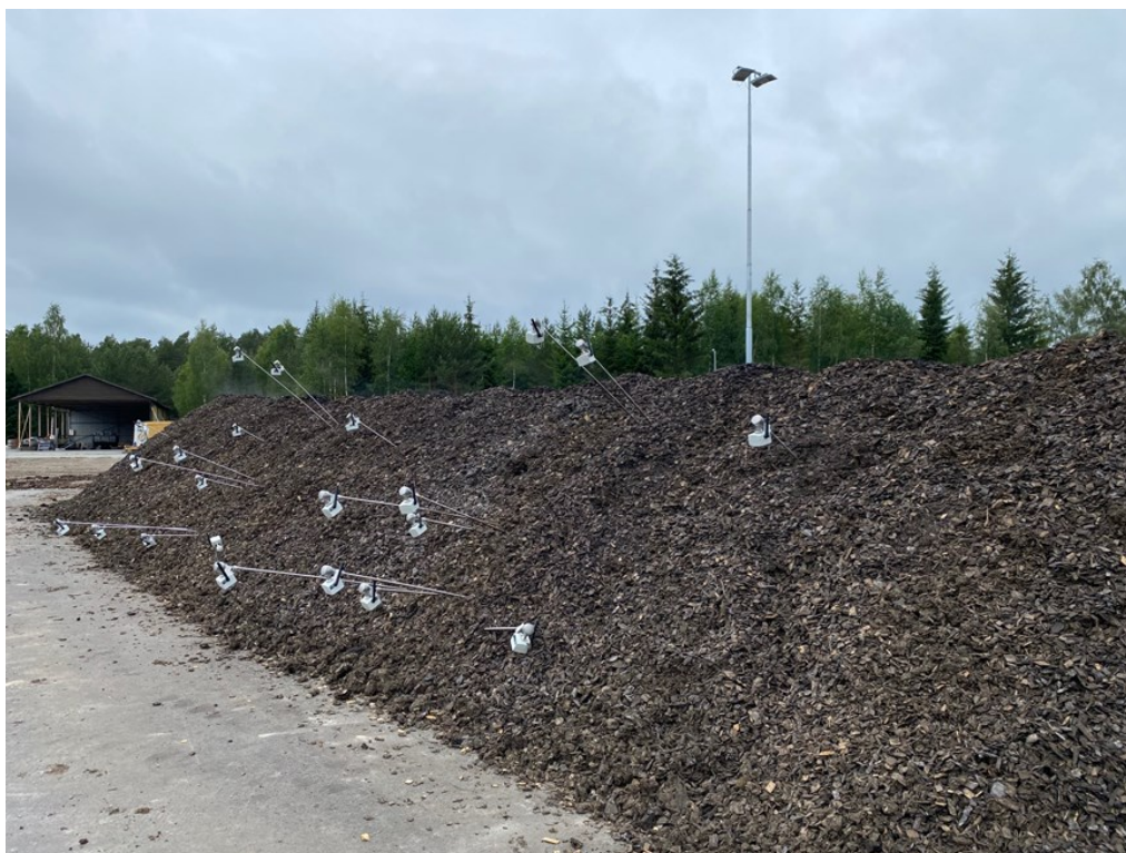
Figur 1. Temperaturutvikling i testranke ble overvåket med 22 termofølere satt inn i ulike dybder og høyder
