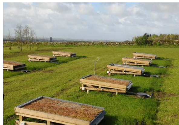
Figur 3. Forsøktak på NIBIO Særheim der ulike samensetninger av jord og vegetasjon blir undersøkt. Foto: Arne Sæbø
