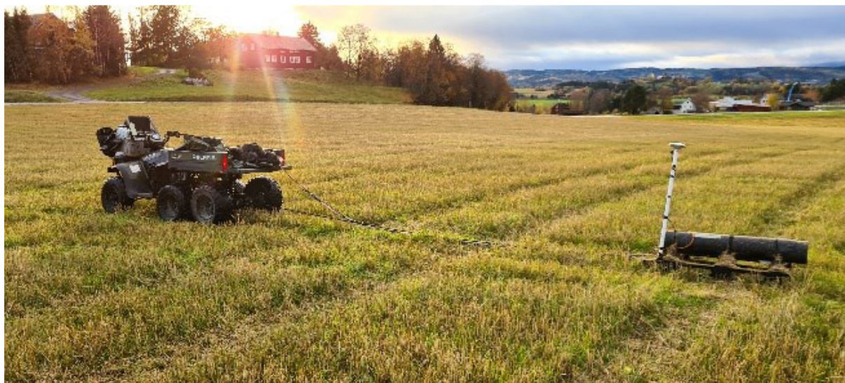
Figur 2. Instrumentet EM 38 brukt i felt på Tuv. Foto: H. Johansen Lindgaard
