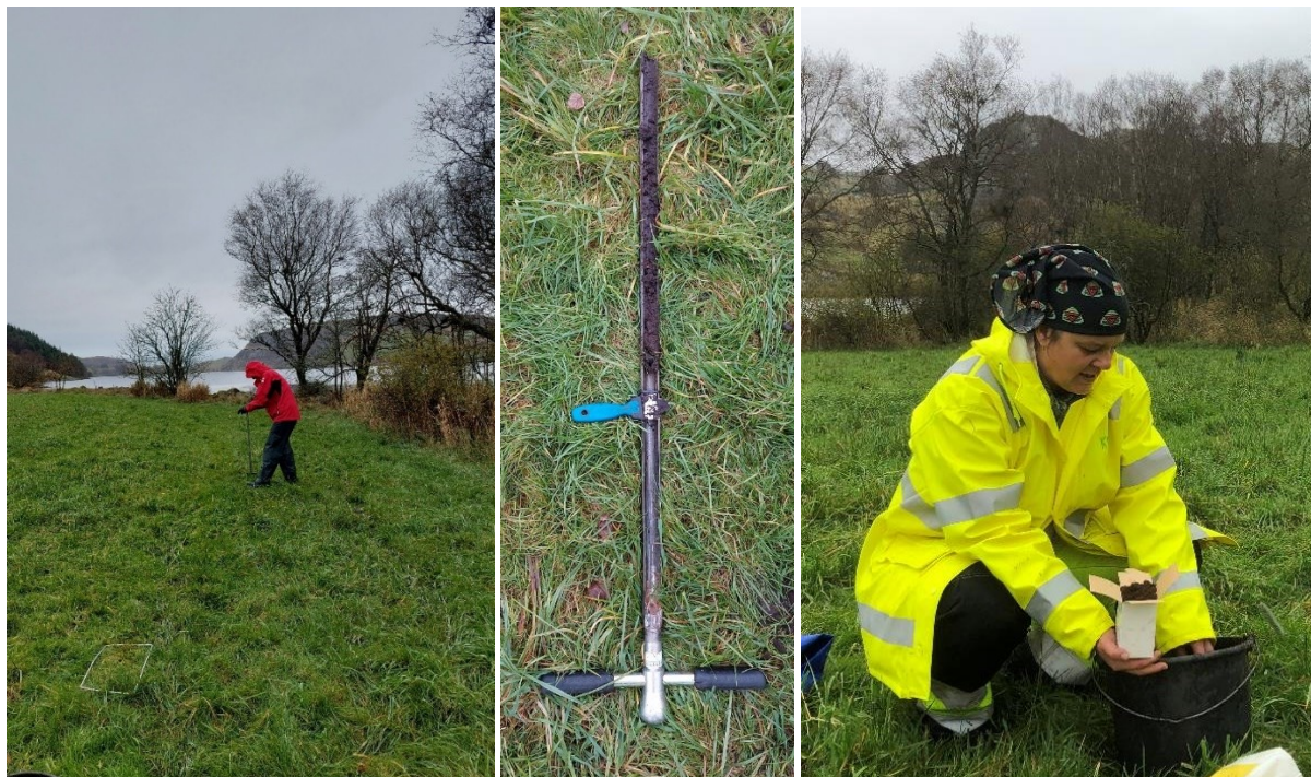
Figur 14. Uttak av jordprøver (venstre) ble gjennomført ved hjelp av et jordbor (midten). Det ble tatt ut 15-20 delprøver som blandes godt sammen (i en bøtte) til en representativ jordprøve fra hvert prøvetakingspunkt. (Foto: venstre og midt: D. Krzeminska, høyre: A-G.B. Blankenberg).
