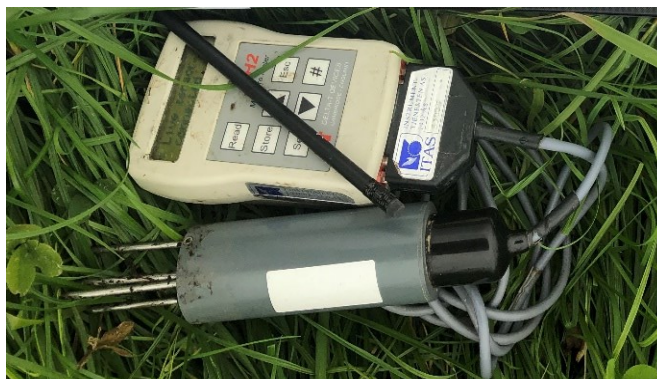
Figur 12. Jordfuktighetssensor, hvor målingene gjøres ved å stikke piggene på enden av proben ned i jorda, og jordfuktigheten vises i displayet på selve måleinstrumentet (Foto: A-G. B. Blankenberg).
