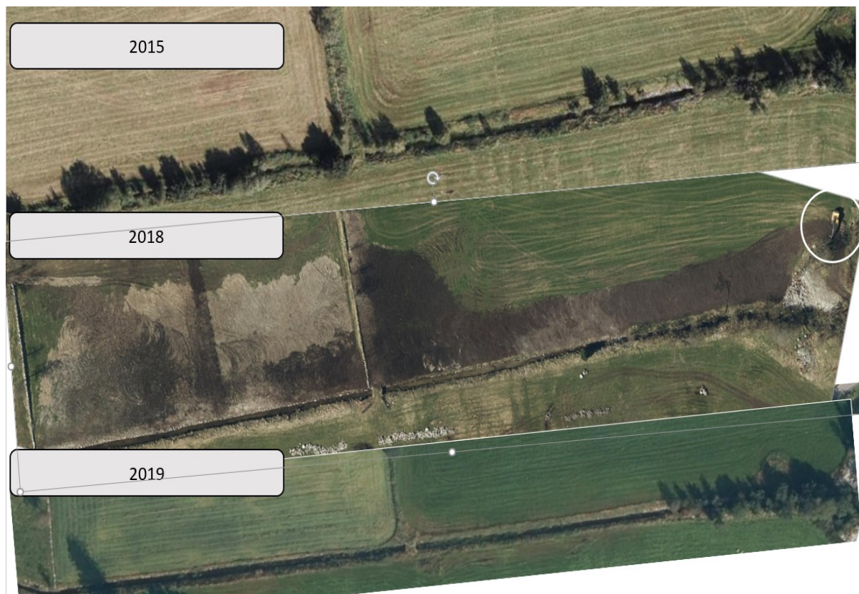
Figur 27. Flybilder fra 2015, 2018 og 2019. På flybildet fra 2018, ser man at jordmasser er gravd opp og ligger spredt utover jordet til venstre i bildet (arealene hvor prøvetakingene er gjennomført). Til høyre i bildet fra 2018 ser man gravemaskinen som rensker opp kanalen (i hvit ring).
