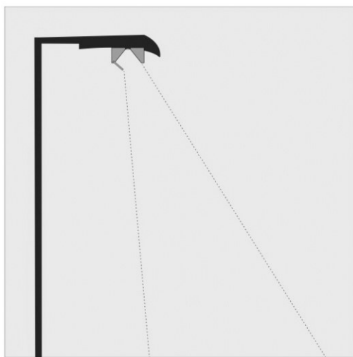
Figur 14: Design av en antatt insektvennlig vegbelysning som nå skal testes ut i Tyskland. Utliggerarmens lengde er 1 meter, vinklet 90° på lysmasta og er svart for å redusere refleksjon av lyset. Lysdistribusjonen styres strengt med mål om en lysstyrke på 0 cd utenfor belysningens målområde. Selve lyspunktet skjermes vha. skodder slik at det ikke så lett kan sees av insekter som befinner seg på nærliggende vannflater, flommark o.a. habitat (Kilde: Figur 1 hos Schroer m.fl. (2021), illustrasjon av Pérez-Vega).
