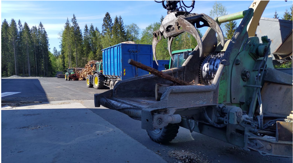
Figur 2. Trommelflishugger brukt for hugging av grov flis til riste- og pilotforsøk.
