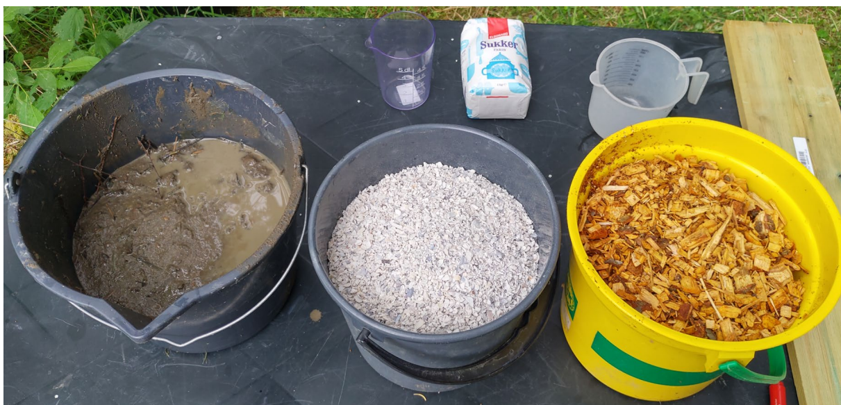
Figur 8. Bekkesediment for inokulering av kim, skjellsand og flishugd gråor samt sukker for god oppstart av filter.
