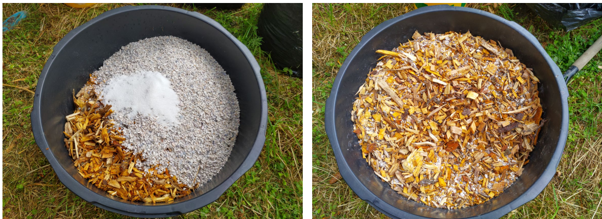
Figur 7. Blandingsdunk før og etter blanding av filtermateriale.
