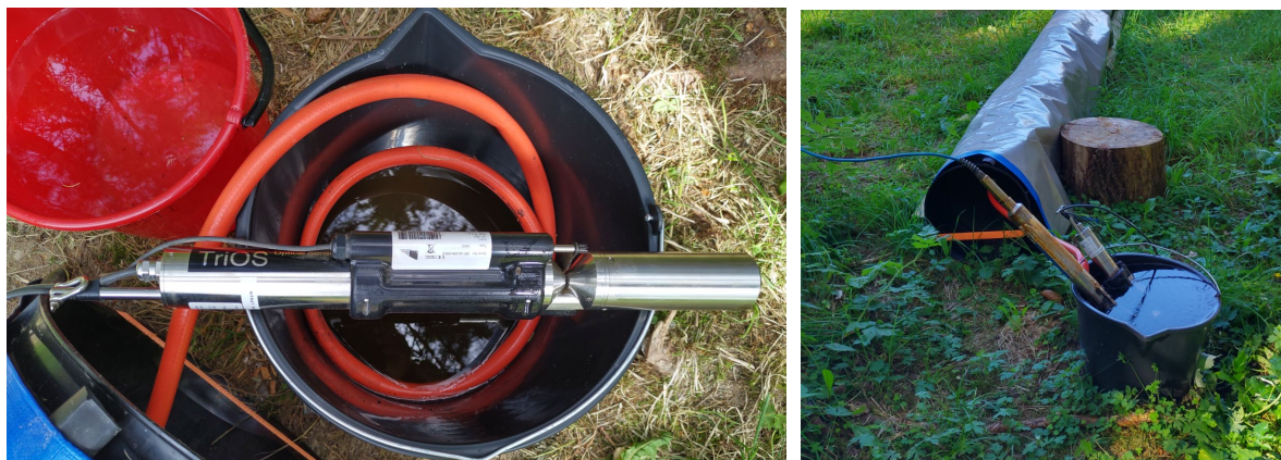
Figur 11. Viser optisk nitratsensor Trios NICO™ samt utløpsbøtte med nitratsensor samt multiparametersonde MPS D8.
