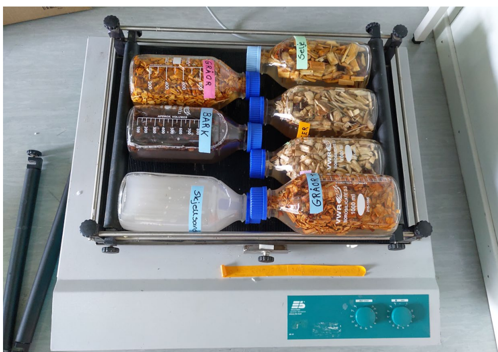
Figur 5. Ristebord med 110 slag per minutt (30 mm utslag) for risting av prøver i 24 timer.
