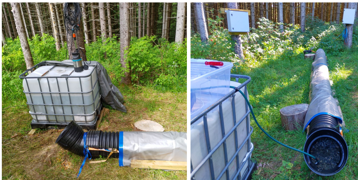
Figur 10. Viser IBC-tank på 600 l for blanding av nitratløsning, lensepumpe for omrøring samt pumpeplange til biofilter.
