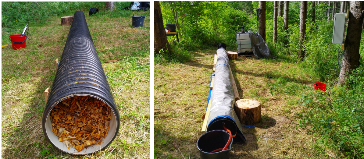
Figur 9. Viser rør (6 m, 300 mm) med filtermateriale samt ferdig filter med endelokk, utløpsslange og 45° bend innløp.
