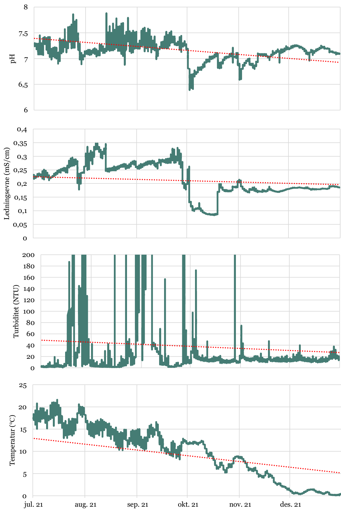
Figur 15. Kontinuerlige målinger av pH, ledningssevne (mS/cm), turbiditet (NTU) og temperatur (°C) i R0åsbekken oppstrøms (ID 91) i perioden 22.04-29.11.2021.
