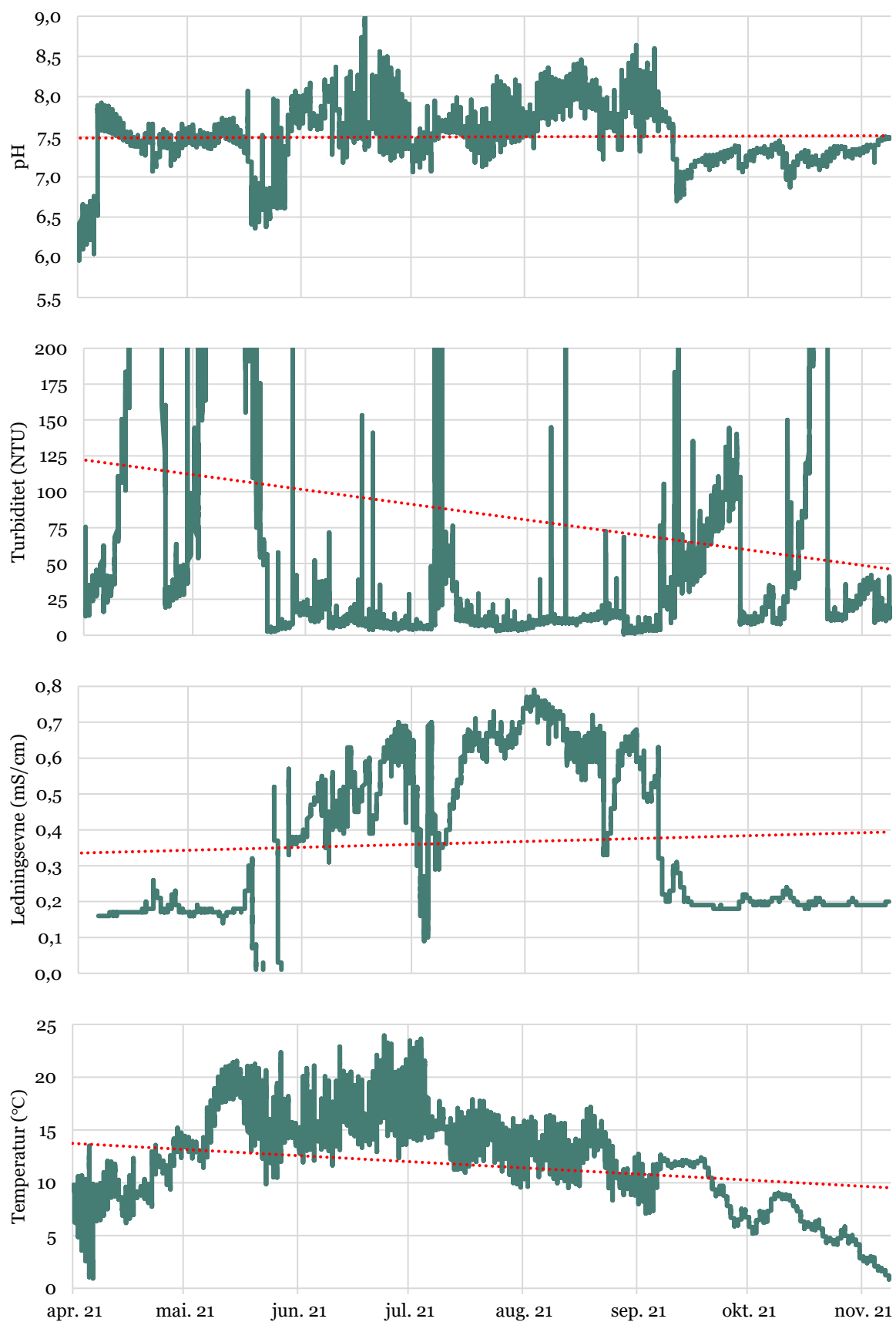
Figur 16. Kontinuerlige målinger av pH, ledningsevne (mS/cm), turbiditet (NTU) og temperatur (°C) i R0åsbekken nedstrøms (ID 92) i perioden 22.04-29.11.2021.
