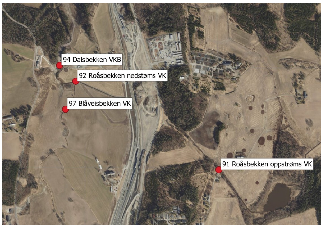
Figur 4. Overvåkingsstasjoner ved anleggsområdene på Ski og Langhus for kontinuerlig overvåking av vannkvalitet og fisk- og bunndyrundersøkelser. V= Vannprøver. K= Kontinuerlige målinger. B= Biologiske undersøkelser.
