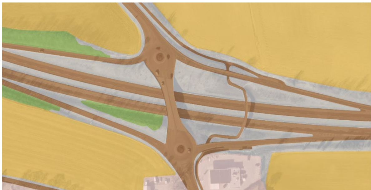
Figur 1: Utsnitt som viser arealtypar i AR5 rundt eit veganlegg. Vegbanane er klassifisert som arealtype samferdsel, vist i brunt, medan grøfter, vegskjæringar og inneklemt restareal er klassifisert som åpen fastmark, vist i grått.
