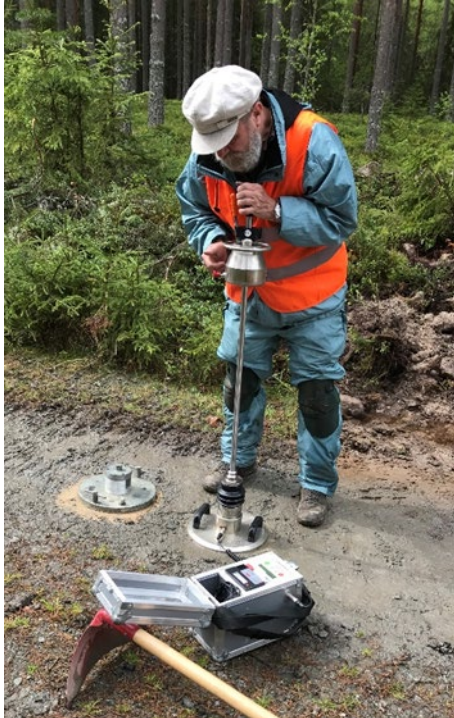
Figur 7. Måling med lettvektsfallodd
