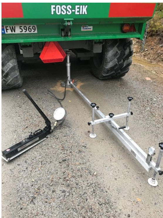
Figur 8. Måling med platebelastning
