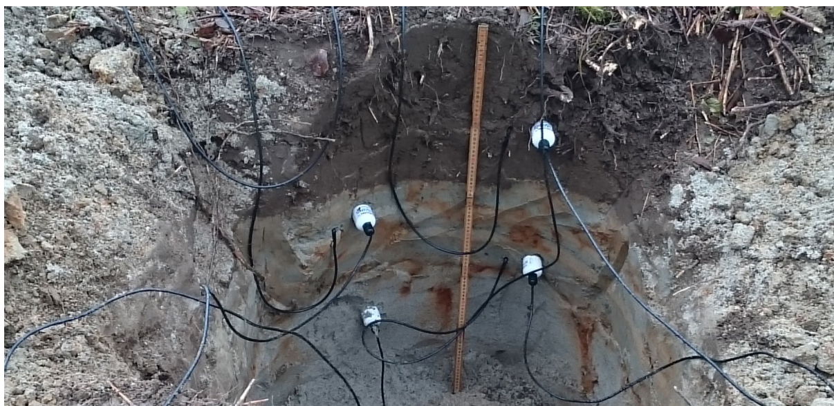
Figur 57. Målere for jordfuktighet og jordtemperatur (Stevens) og redoksmålere (Eco Tech) installert på 20, 40, 60 og 80 cm dyp ved jordekanten på Rimstadmoen.
