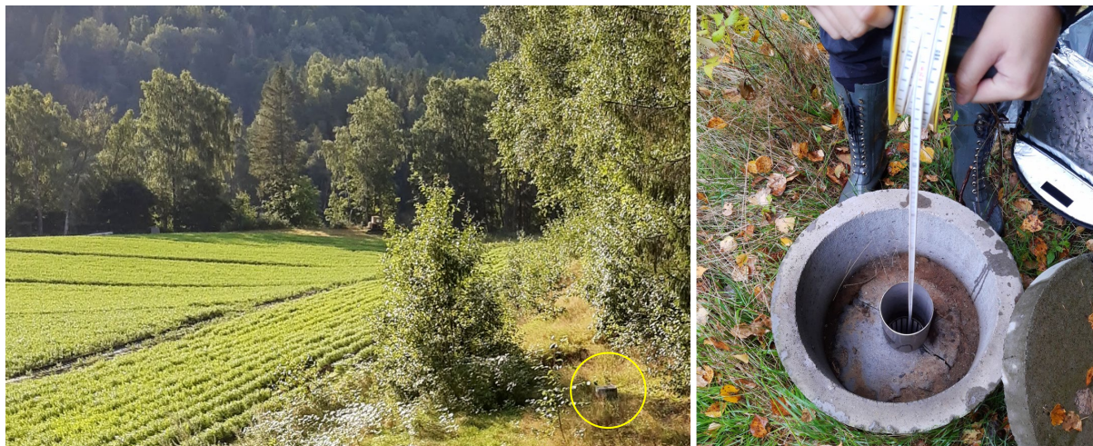
Figur 20. Grunnvannsbrønnen på Rimstadmoen under prøvetaking i 2020 (Foto: Charles H. Carr).
