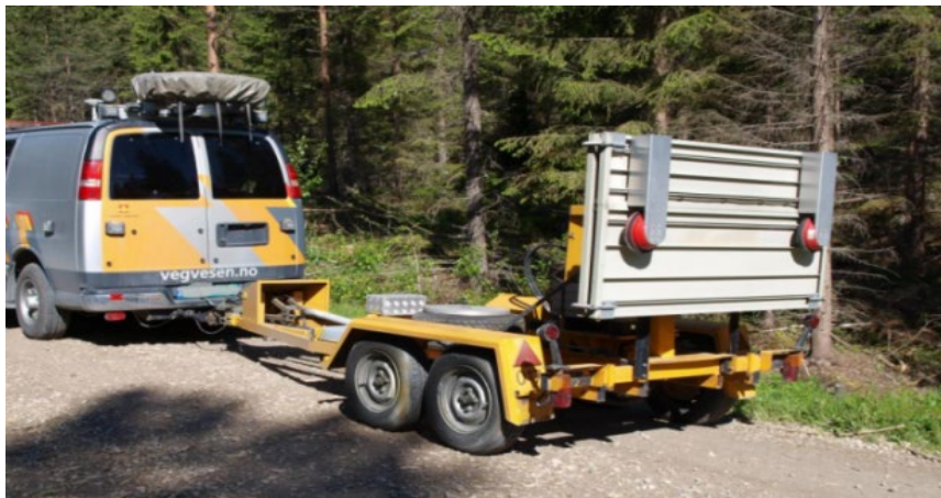
Bilde 2: Lettvekts fallodd Zorn ZFG 3.0 (t.v., fra Internett) ble benyttet til å registrere e-modul i prosjektet. Konvensjonelt fallodd (t.h. hengermontert, foto: Jan Bjerketvedt) fra Statens Vegvesen ble benyttet på et utvalg av veiene for å se på korrelasjon ved målinger av bæreevne.
