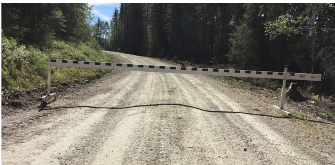
Bilde 6: Laserprofil og målefoto ble brukt for å identifisere hjulspor og veimidt. Foto: Martin Bråthen.
