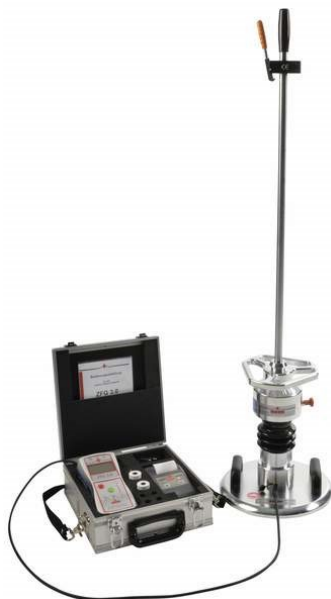
Bilde 2: Lettvekts fallodd Zorn ZFG 3.0 (t.v., fra Internett) ble benyttet til å registrere e-modul i prosjektet. Konvensjonelt fallodd (t.h. hengermontert, foto: Jan Bjerketvedt) fra Statens Vegvesen ble benyttet på et utvalg av veiene for å se på korrelasjon ved målinger av bæreevne.
