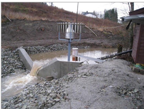
Figur 2. Det nye V-overløpet som ble anlagt i Kolstadbekken i 2012. Nedbørmåleren ses midt i bildet, målehytta til høyre. Foto: NIBIO.
