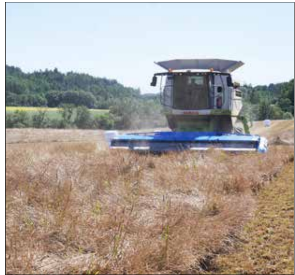
Bilde 2. Kjøring med konvensjonelt skjærebord (til venstre) og ribbeskjærebordet (til høyre) i frøeng av Figgjo flerårig raigras 29. juli 2022. I bildet til venstre står personale fra NLR Viken klar med oppfangerplata for å bestemme frøspill over sålda. Foto: John I. Øverland.
