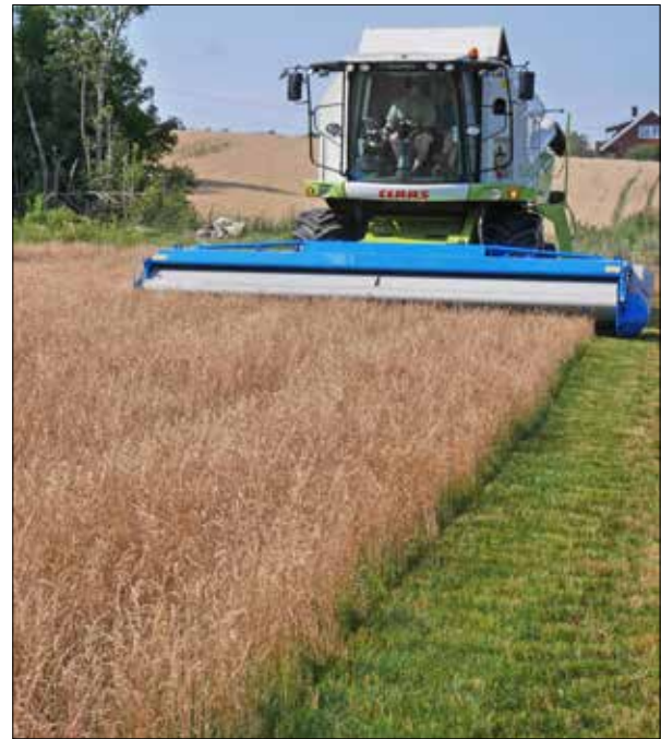
Bilde 3. Tresking med ribbeskjærebordet i frøeng av Frigg rødsvingel i Stokke, Sandefjord, i 2022. Foto John I. Øverland.
