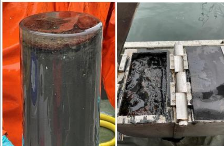
Kjerneprøve fra HOL-M (venstre) og grabbprøve (høyre). Sedimentet var svart og luktet av H 2 S, og overflaten dekket av bakteriebelegg eller bentiske kiselalger
