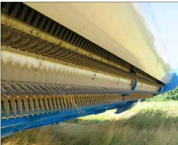
Bilde 1. Ribbeskjærebordet består av åtte rader med strippende fingre som slår frøet ut av akset eller frøhodet når det roterer. Foto: Lars T. Havstad.
