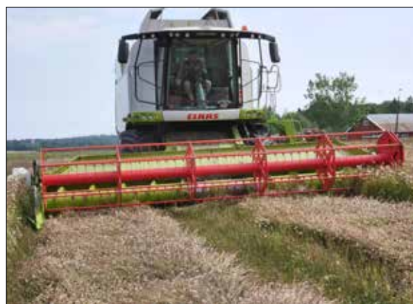
Bilde 2a,b. Skårlegging av prestekrage 18. juli (t.v.) og tresking av skårlagte strenger to dager seinere (t.h.). Fordi bredden på skårleggeren og skjærebordet var henholdsvis 3,0 og 6,6 m, var det ved tresking av ledd 1 ikke til å unngå at ei 60 cm brei stripe ble direktetreska sammen med de skårlagte strengene. Foto: John Ingar Øverland.
