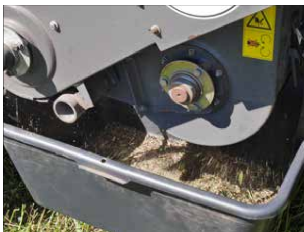
Bilde 3. Frøavlingene ble samla opp i ei balje hengt opp i overgangen mellom bunnskruen og elevatoren til tanken. Bildet er fra tresking av knoppurt 27. juli. Foto: John Ingar Øverland.
