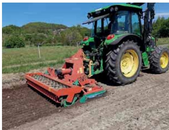
Bilde 1. Mekanisk brakking med rotorharv den 17. juni 2020 for å holde ugraspresset nede før såing i midten av august (ledd 3). Foto: Lars T. Havstad.
