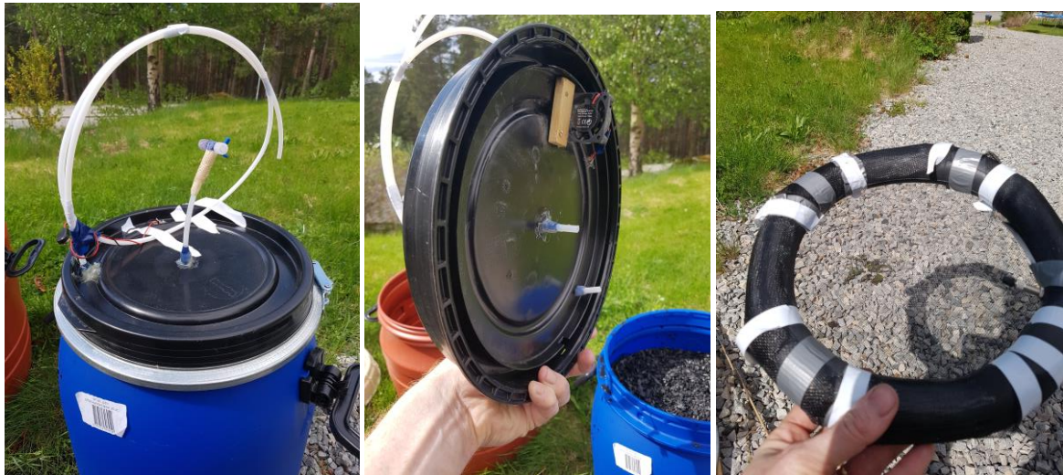
Fig. 2 Treveisventil til gassprøvetaking (til venstre), batteristyrte vifte til blanding av gassene før prøvetaking (midten), en gjennomtrengelig membran laget av fluenetting (vanskelig å se i bilde) og sykkeldekk som ble brukt for å sørge for at biokullet holdt seg flytende (til høyre)
