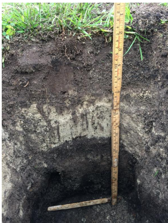
Bilde 10. Profil 2: 12 cm matjord (A-sjikt) over 12 cm sandlag bestående av mellomsand/ finsand ( B-sjikt). Deretter 25 cm mineralblanda moldjord (C-sjikt) ned til hardpakka koksgrus.
