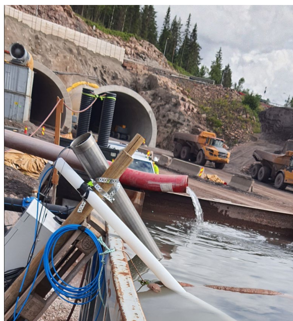
Figur 9. Nitrat- og multiparametersensor montert i container med tunnelvann (Foto: Elise M. Sverdrup).
