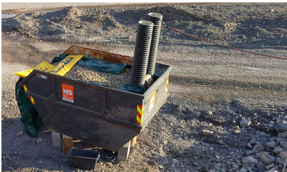
Figur 5. Pumpet tunnelvann fordeles på begge innløpsrør for nitrifikasjon og renner umettet ned i filterbassenget.
