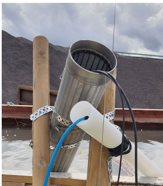
Figur 9. Nitrat- og multiparametersensor montert i container med tunnelvann (Foto: Elise M. Sverdrup).
