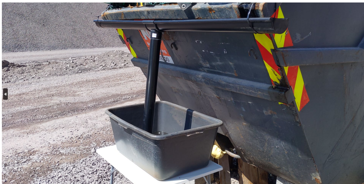
Figur 6. En takrenne i plast fører rensset avrenning fra pilotfilteret ned i et overløpskar (65 l) for uttak av vannprøver.
