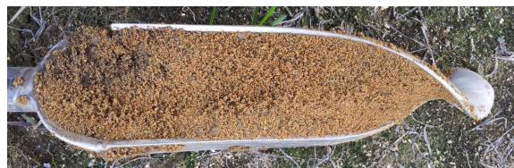
Jordbor med jord som hovedsakelig inneholder sand. Denne jorda faller lett fra hverandre (foto: Åge Nyborg / NIBIO).
