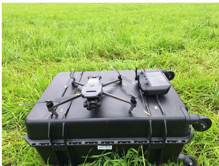
Figur 4 Dronemodell DJI MAVIC 3T som gjerne brukes av dyreeiere på utmarksbeite. Kameraet har en 48 MP CMOS sensor med bildestabilisert kamerahus på 3-akset Gimbal. Foto: Georgios Koutsopoulos
