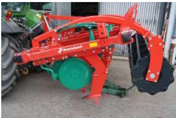
Bilde 1. Horisontal rotskjærer (prototype fra Kverneland) brukt i forsøkene. Foto: Lars Olav Brandsæter
