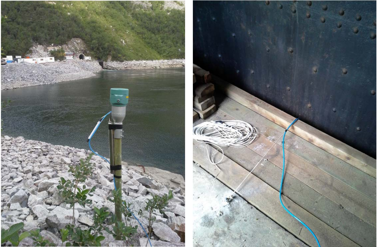
Figur 7. Ny plassering av logger utenfor lukehus ved Strandvatn og med MPS dykket ved luke.
