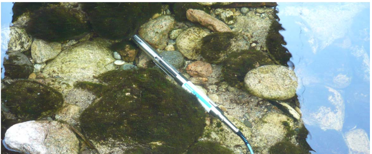
Multiparametersonde for automatisk vannovervåking i Stølsåna, juni 2013.
