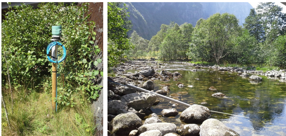
Figur 7. Stasjon for automatisk overvåking av vannkvalitet i Stølsåna. Logger står plassert under bru og multiparametersonden ble plassert i perforert metallrør i elva.
