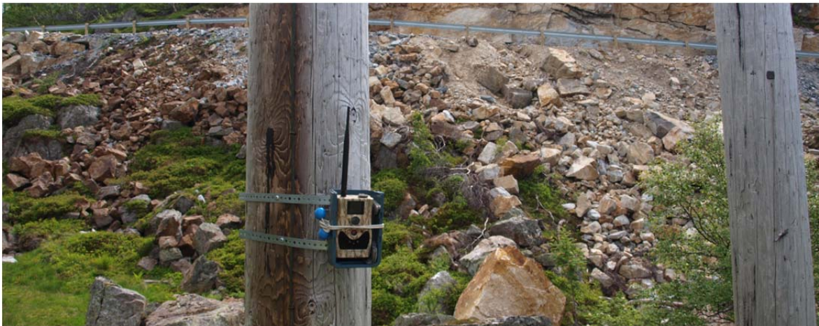
Viltkamera for visuell overvåking av vannkvalitet ved Strandvatn, 23. juni 2014.
