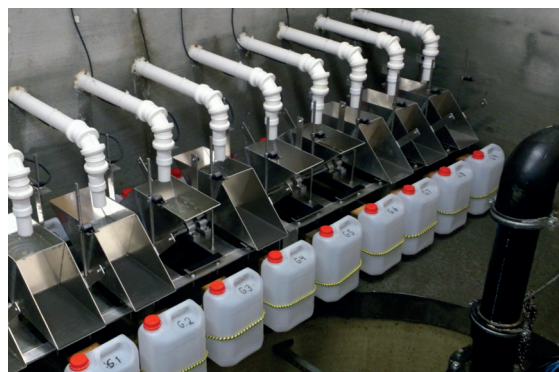
Avrenningsmålinger og uttak av vannprøver med vippekar
